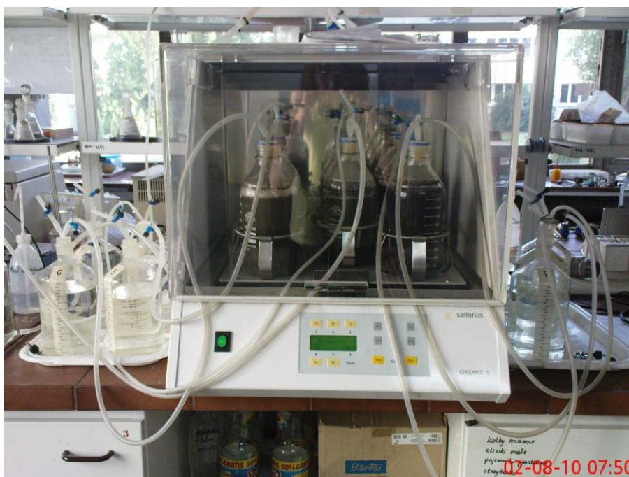
Rys. 3. Stanowisko badawcze do analiz BMP (Biochemical Methane Potential)
