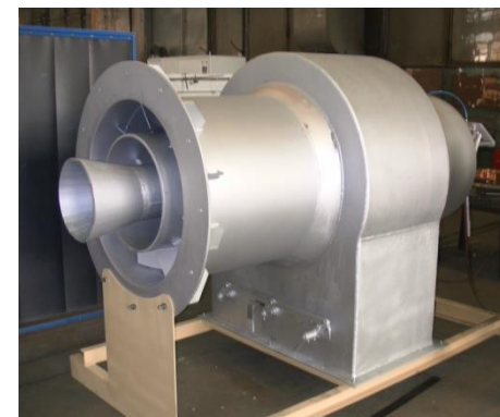
Palnik wirowo-strumieniowy do spalania rozdrobnionej biomasy o mocy 22MW
