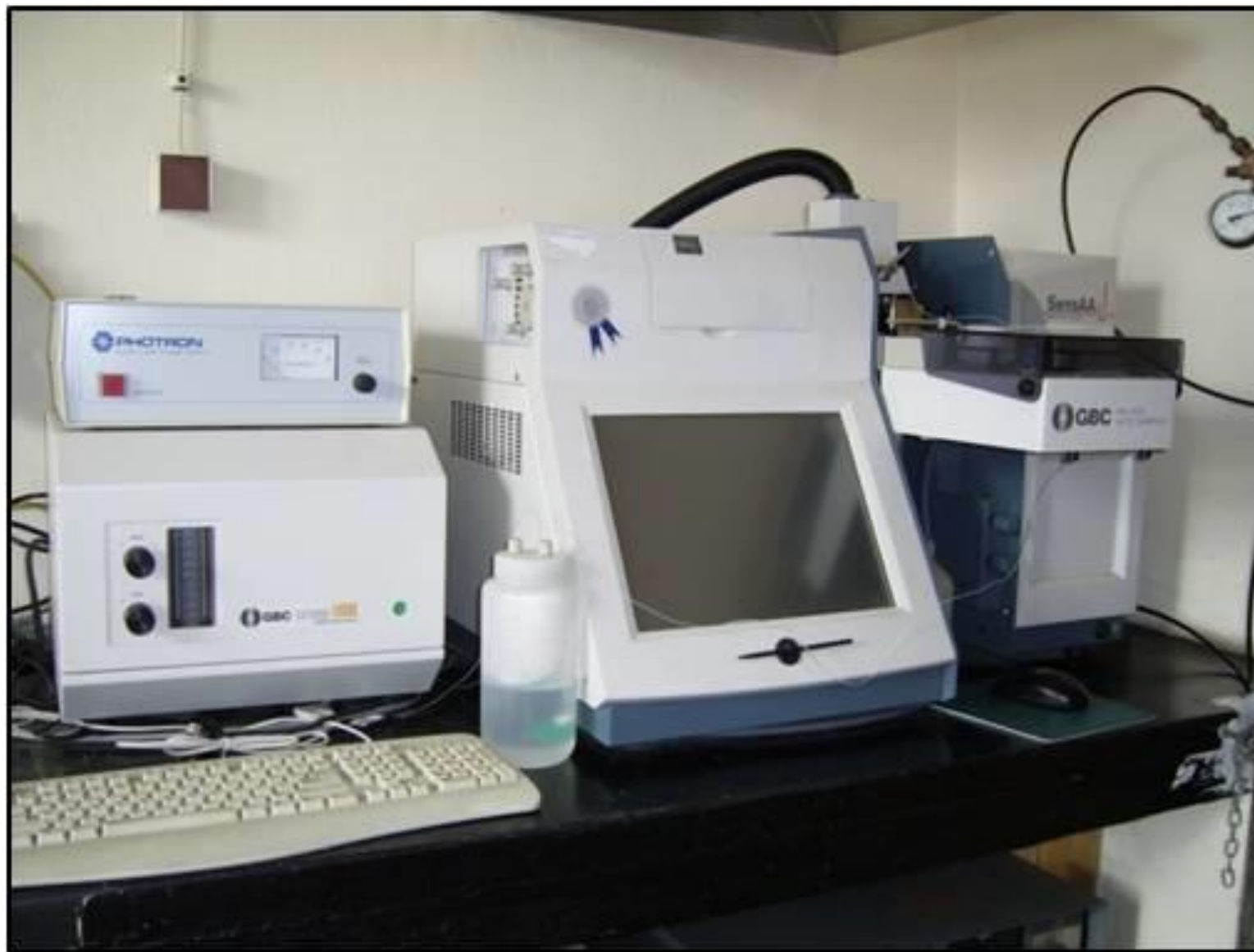
Spektrometr absorpcji atomowej z atomizacją elektrotermiczną, SenSAA, GBC
