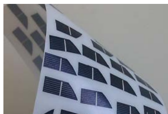
Rys. 1. Półelastyczny moduł testowy, wykonany z monokrystalicznych ogniw krzemowych, produkcji ENECOM S.R.L. (fot autora)
