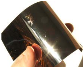
Rys. 5 Polikrystaliczna warstwa CdTe wraz z kontaktem bazowym Cu otrzymana na polimerowej folii elastycznej UPILEX®
