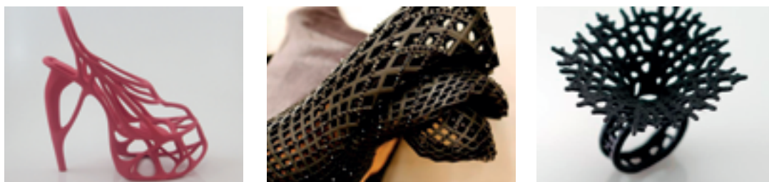
Rysunek 24. Przykłady zastosowania technologii druku 3D w przemyśle tekstylnym, obuwniczym i jubilerskim.
