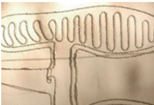
Rysunek 21. Podgrzewana wkładka do butów.
