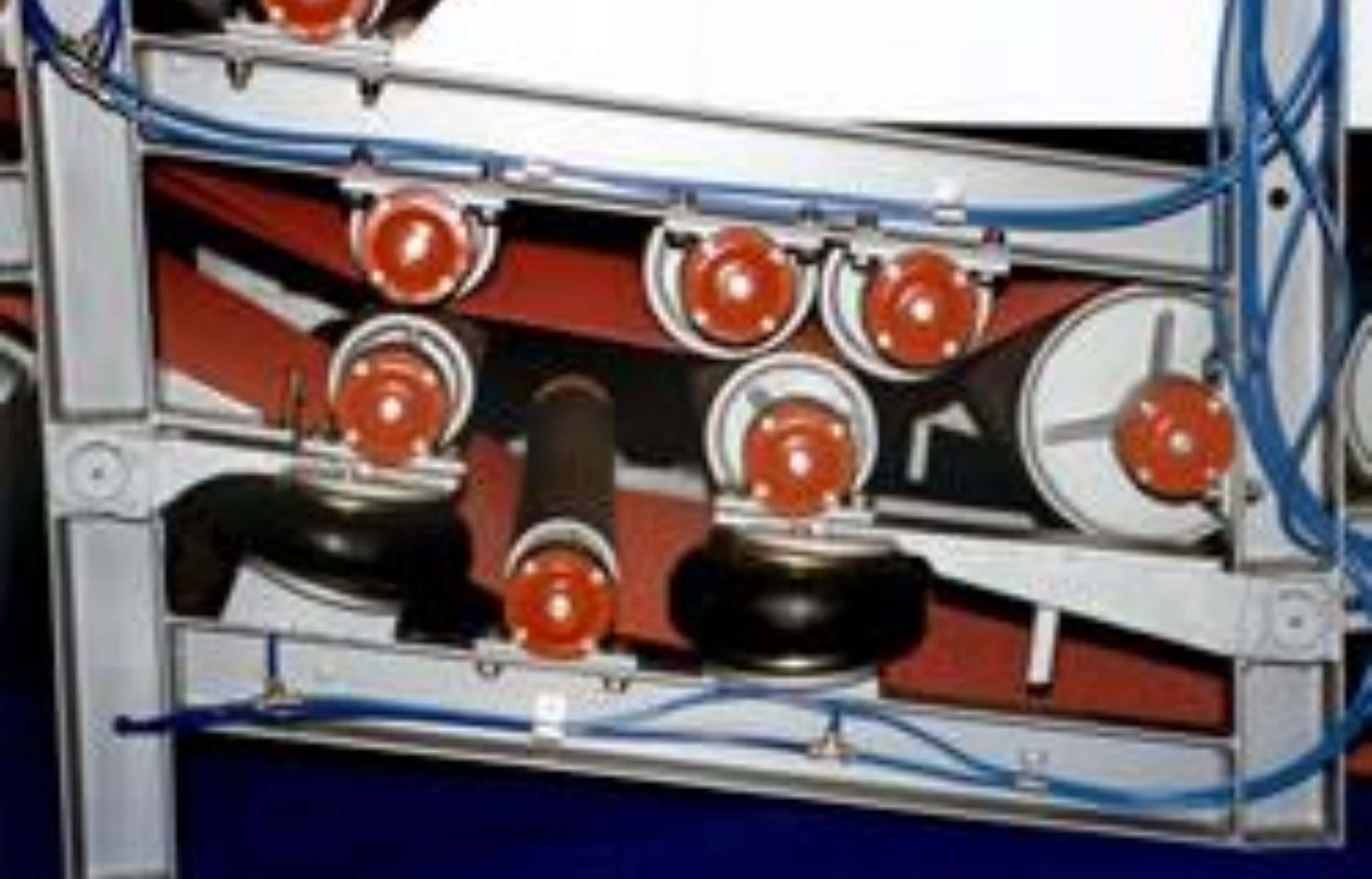
Strefa wysokociśnieniowa w prasie taśmowej typu VX-VT
