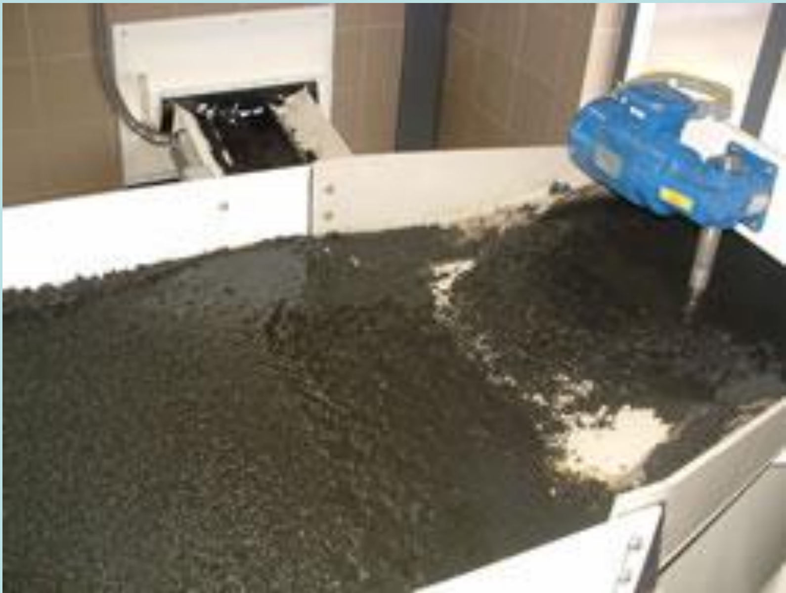
Flokulator dynamiczny FX-FZ z mieszadłem
