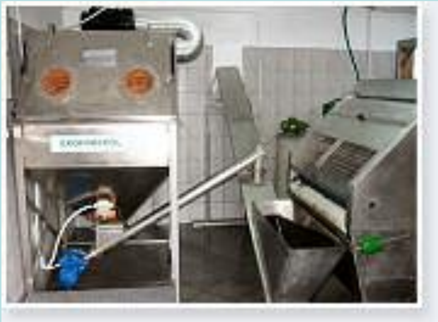
Dozownik wapna i układ do higienizacji osadu
