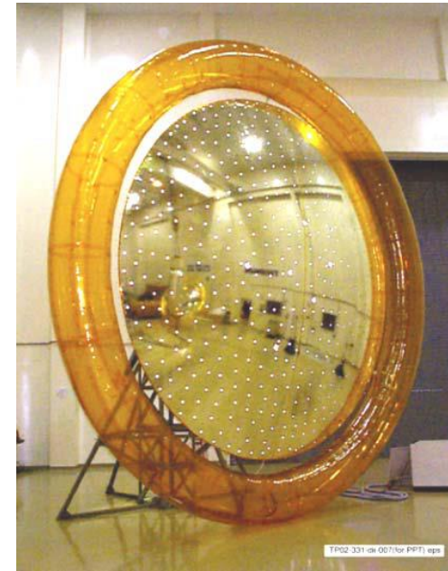
Antena rozpięta na stelażu pneumatycznym.
