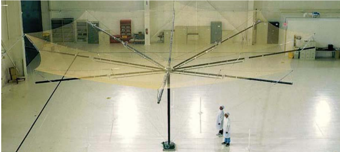
Siatka na rozłożonym stelażu żebrowym o rozpiętości 12 m.
