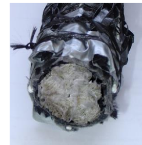
Przekrój poprzeczny liny (osłona, rdzeń).
