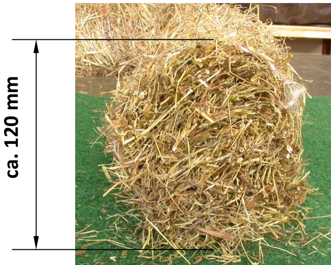
Lina z siana górskiego stosowana w geosiatkach chroniących zbocza przed erozją.
