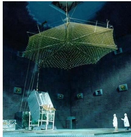
Siatka na rozłożonym stelażu żebrowym o rozpiętości 12 m.
