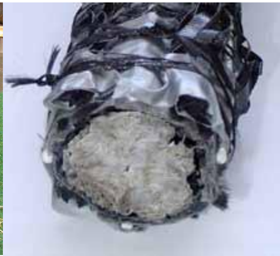
Liny stosowane do monitorowania i odwadniania wałów przeciwpowodziowych, tam i zapór.
