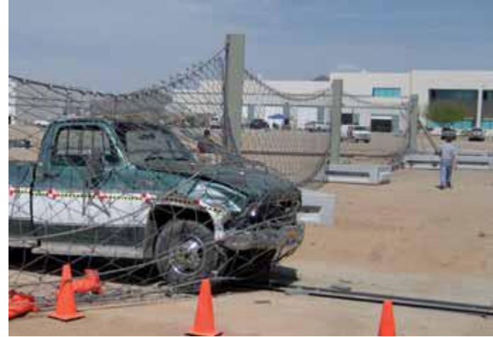
Bariera dynamiczna jako ochrona granicy USA z Meksykiem. Na rycinie pokazano wynik testu z ciężarówką o masie 4500 kg, rozpędzoną do 65 km/h
