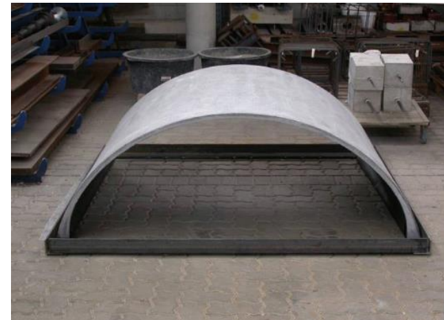
Półcylindryczne kształty elementów betonowych (metoda natryskowa)
