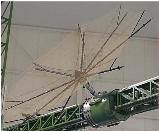
Siatka na rozłożonym stelażu żebrowym o rozpiętości 12 m.
